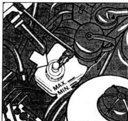
Объем наполнения должен достигнуть верхней отметки MAX /проверяется снаружи/. В любом
