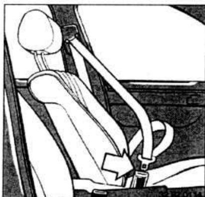
Перед каждой поездкой на автомобиле следует надевать ремни безопасности! При каждом замыкании замок ремня должен срабатывать со щелчком.
