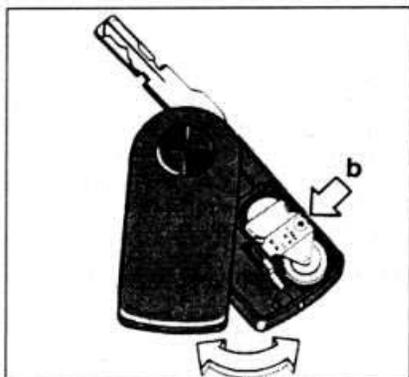
Спецификация и монтажное положение батареек отштампованы на держателе батареек.
